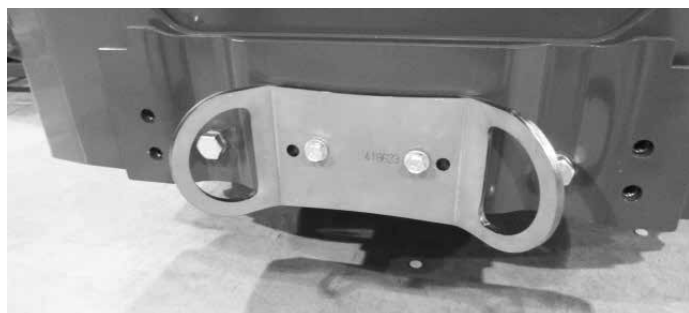
Nedre beslag A418623 monteret på bagerste kofanger eller modvægt
