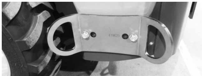
Nedre beslag A418623 monteret på sideramme Ved montering på sideramme er det nødvendigt med to beslag.
